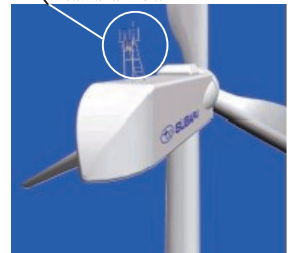
(図 1) 風向風速計: SUBARU80/2.0 耐風性能を強化したといわれる
