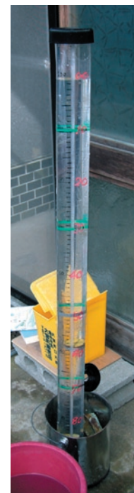
左上：丹後半島の水系図（部分）、上：簡易透視度計 いずれも平井久夫氏製作
